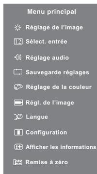
Par exemple, pour corriger la position verticale, sélectionnez l'élément Régl. de l'image du Menu, puis appuyez la touche ENTER. Puis, sélectionnez Géométrie en utilisant les touches ◀/▶ . Une page d'ajustement apparaît après l'appui sur la touche ENTER. Puis, sélectionnez Position V. en utilisant les touches ◀/▶ .
